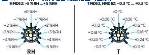
图 2. RH 和 T 微调电容调整范围 (图示)
