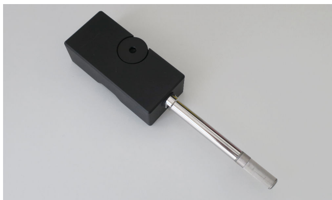
带有不锈钢网过滤器的 HMP371 探头
