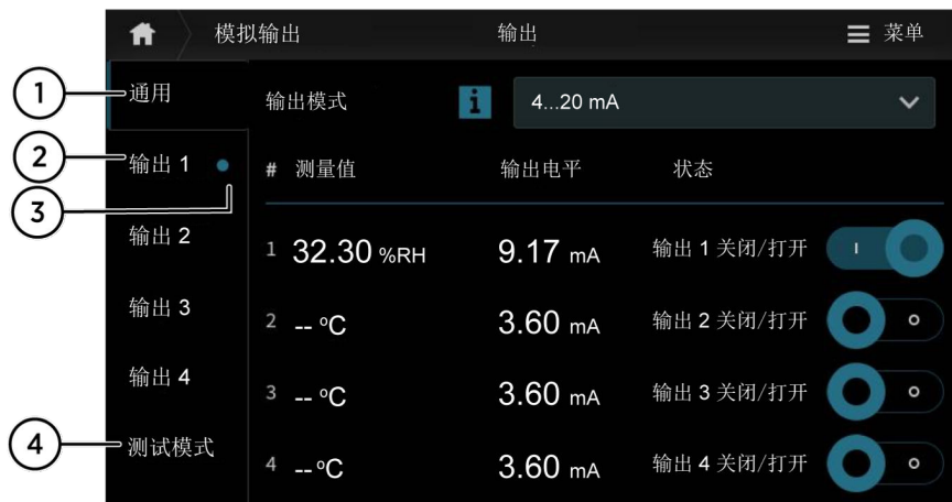
图 32 触摸屏上的模拟输出配置菜单，常规选项卡处于活动状态
